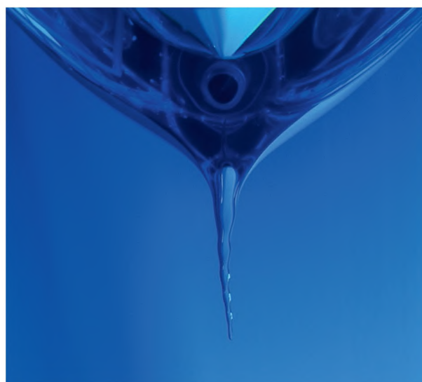
FIGUR 5. Når man stopper rotationen (i dette tilfælde på max-hastighed), forbliver hvirvlen der i nogen tid, men bliver ustabil og kraftigt deformet. Her igen tilsat blå farve. Foto: Barbara Bohr.
